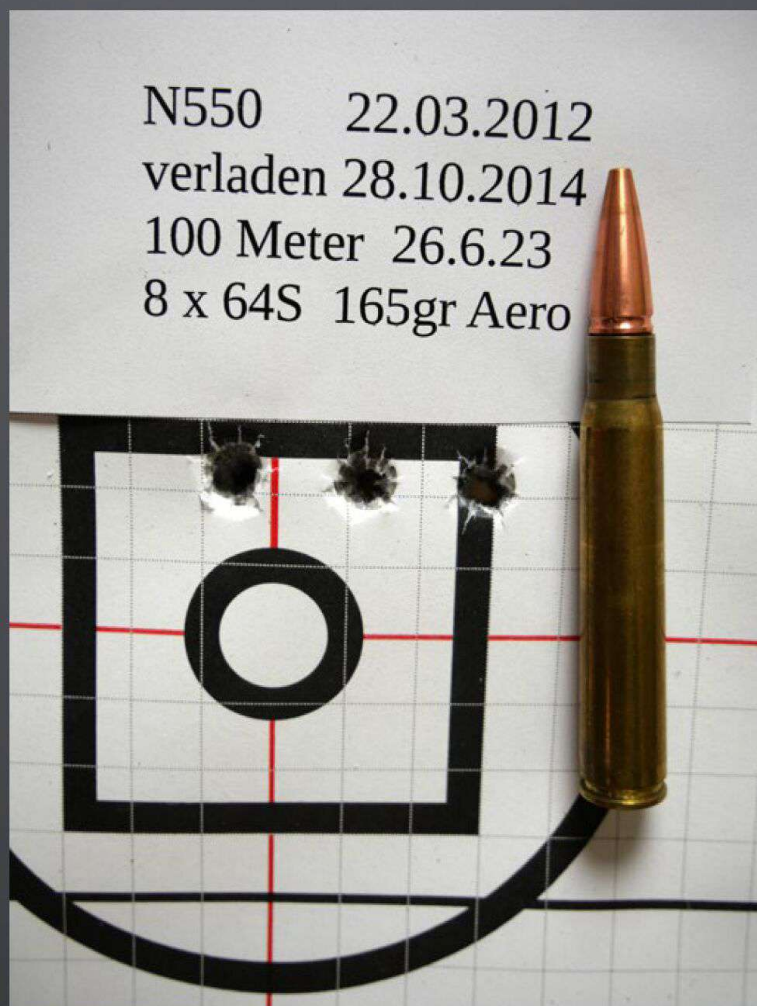
DIE BILDER SPRECHEN FÜR SICH! Links die 8x64 S verladen mit dem N550 aus dem Jahr 2012, daneben das Schussbild der 8x64 S mit Pulver N550 von 2020.
