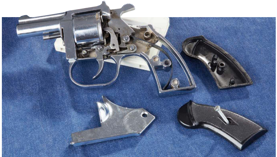
Gussnähte, Wurfpassungen und Lunker – schön ist anders! Auch die Funktion des ungenau arbeitenden Schlosses dürfte nur für einige Schachteln Munition reichen.
