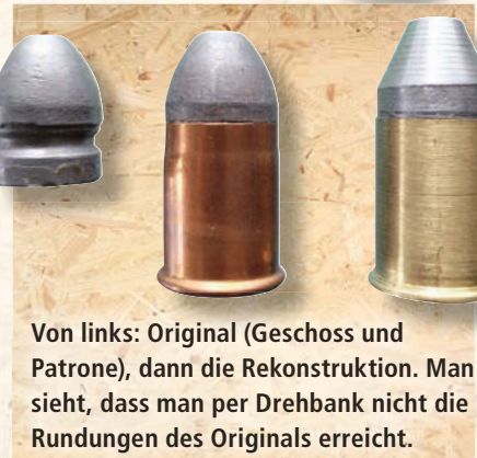
Rekonstruktion mit selbstgefertigter Hülse und auf der Drehbank gefertigtem Bleigeschoss, fertig zum Verfeuern.
