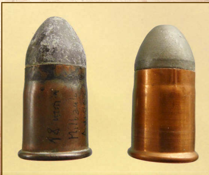
Zwei Randfeuerpatronen für die großkalibrigen Umbauten nach Milbank-Amsler – die damaligen Hülsen bestanden aus Kupfer, nicht aus Messing.
