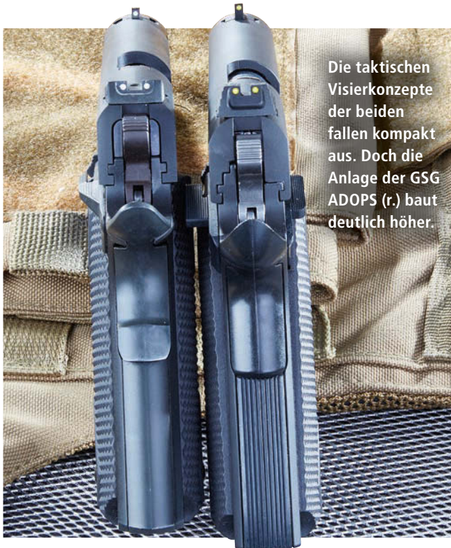
Die KK-1911er greifen beide auf eine Lauflagerung mittels Laufbrillenstück (Bushing) im Mündungsbereich zurück.
