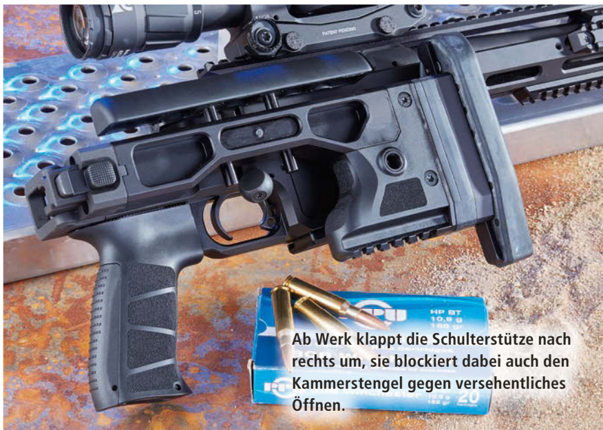
Das spielfreie Klappgelenk aus Stahl lässt sich durch Lösen von vier Schrauben abnehmen und dann auch links anschlagend umsetzen.
