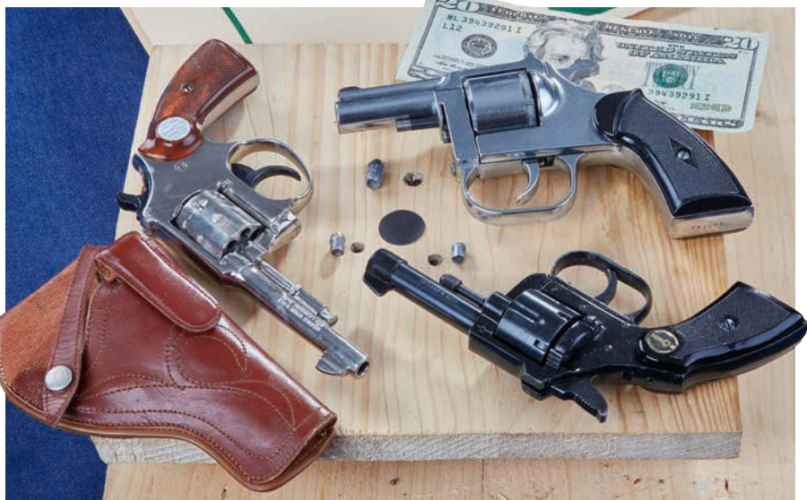
Die wollten nicht nur spielen: Selbst die .22 short durchschlägt fast zwei etwa 18 Millimeter dicke Weichholzbretter. Die .22 l.r. HV penetriert danach noch gut acht Zentimeter Clear Ballistics. Das Projektil der .32 S & W steckte mit der halben Geschosslänge in einem dritten Brett. Keiner der kleinen Billigrevolver war harmlos.
