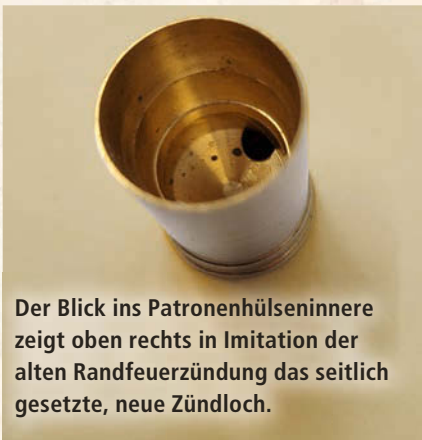
16er Schrothülse als Basis zur großen MA-Patrone: Seitlich platzierte 6-mm-Flobert-Platzpatrone als Zünder, originales Zündloch noch nicht verschlossen.
