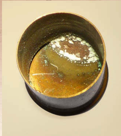
Das Dreieck zeigt bei der MA-Randfeuerhülse an, wo sich der Treibsatz befindet. Dessen Position sieht man auch beim Blick ins Patronenhülseninnere.
