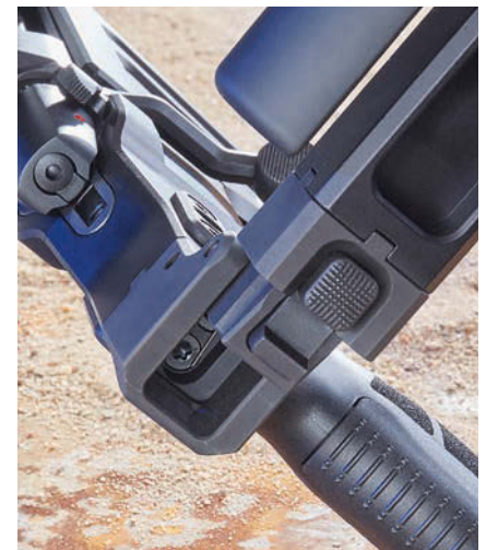
Das spielfreie Klappgelenk aus Stahl lässt sich durch Lösen von vier Schrauben abnehmen und dann auch links anschlagend umsetzen.
