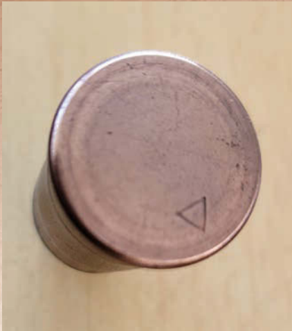
Das Dreieck zeigt bei der MA-Randfeuerhülse an, wo sich der Treibsatz befindet. Dessen Position sieht man auch beim Blick ins Patronenhülseninnere.
