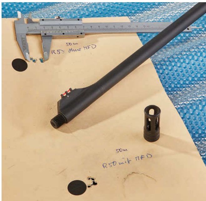
Signifikante Unterschiede traten bei abgenommenem Mündungsfeuerdämpfer nicht auf. Die Streukreise halten Match-Niveau.
