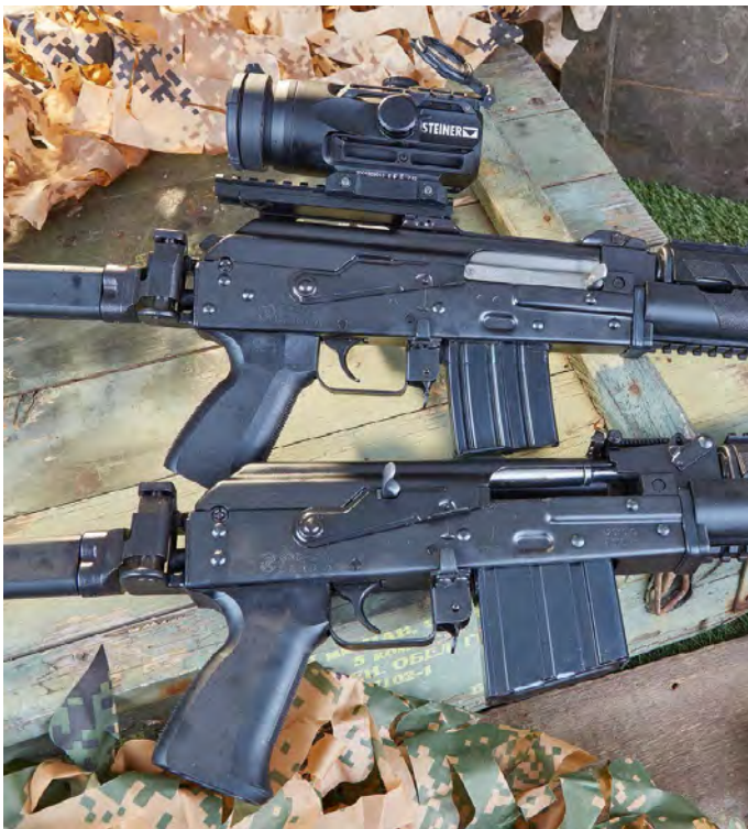
Nur die Version in .308 Winchester (v.) hat einen Verschlussfang. Der Unterschied der Magazine ist beträchtlich.
