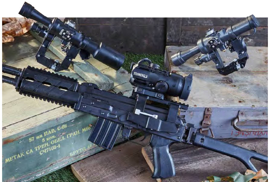
Voller Durchblick: Geschossen wurde mit der montierten Steiner-Optik, einer S 432 (4 x 32 mm), die russischen Schwabe-ZFs kamen leider erst nach dem Test. Rechts ein ZF 4 x 24, links das Pendant in 6 x 36 mit Hammerschlag-grauer Beschichtung.
