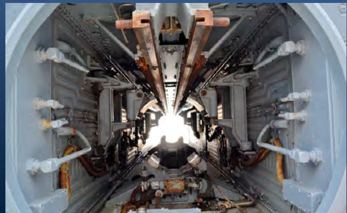
Blick in einen ASROC-Starters der „Mölders“ – konzipiert für Tiefwassereinsatz. Deswegen in Nord- und Ostsee nur bedingt einsatzfähig. Man dachte eher an weltweite Missionen.
