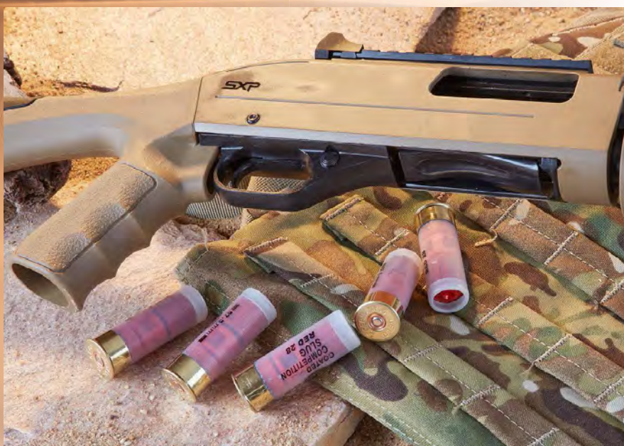
Der Druckknopf vorn im Abzugsbügel fungiert als Sicherung der SXP.
