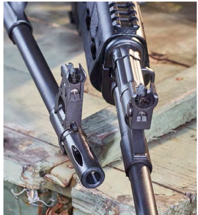
Links das böse Ende der M 2010 G in .308 Winchester mit dem Korn direkt an der Mündung. Beide Modelle verfügen über das höhen- und seitenverstellbare Stabkorn, zusätzlich ein davor klappbares Nachtkorn mit weißem Punkt.
