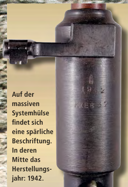
Der abklappbare Tragegriff im Schwerpunkt der Waffe erleichtert das Verbringen des Gewehrs, das schon ungeladen über 16 Kilo wiegt.
