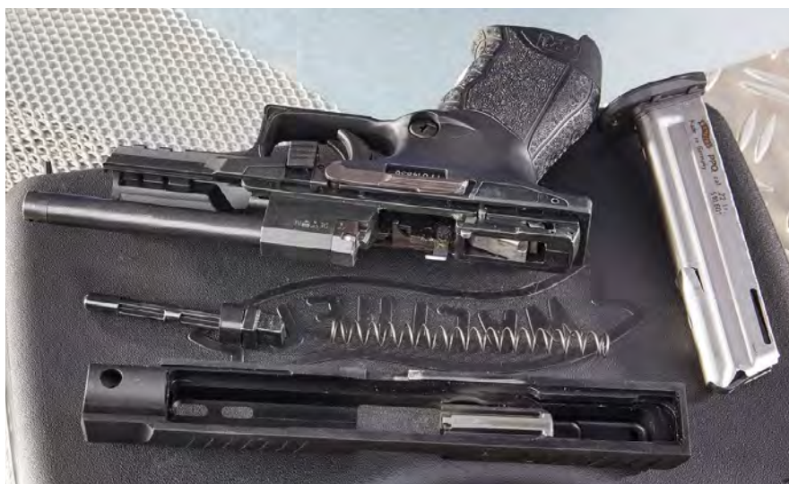
Die fünfzöllige PPQ M2 zerlegt in ihre Hauptbaugruppen (von oben): Griffstück mit Lauf, Führungsstange und Schließfeder, Leichtmetall-Verschluss. Rechts: das Magazin.
