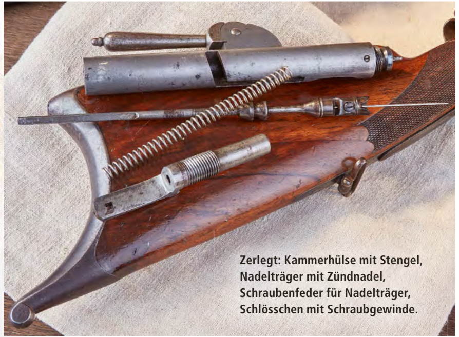
Der ausgebaute Verschluss: Die Nadel im Inneren. Der Kammergriff ist zum Bedienen zur Seite hin um 90 Grad nach außen abgeklappt.
