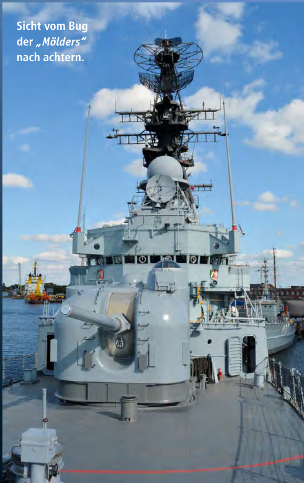
Blick in einen ASROC-Starters der „Mölders“ – konzipiert für Tiefwassereinsatz. Deswegen in Nord- und Ostsee nur bedingt einsatzfähig. Man dachte eher an weltweite Missionen.
