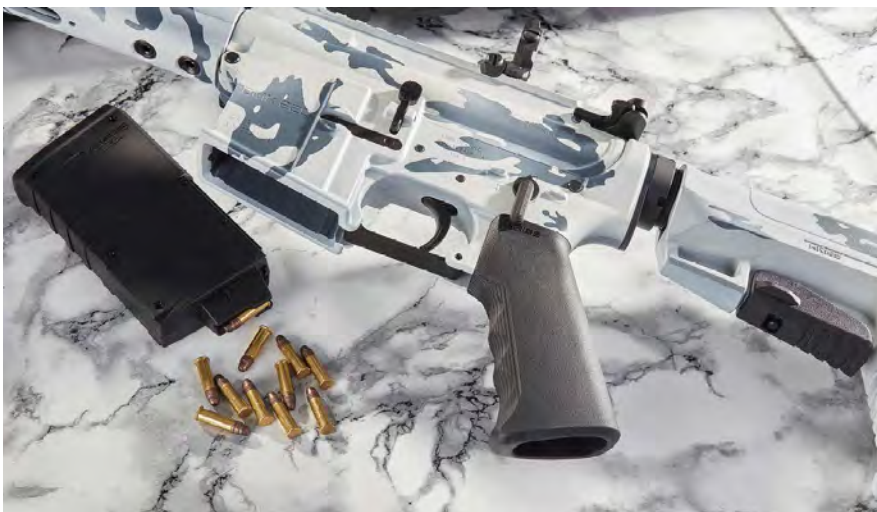
Der Verschlussfang hat andere Maße, arbeitet aber wie bei einem AR-15. Alle anderen Bedienelemente entsprechen 1:1 dem Vorbild von Armalite.
