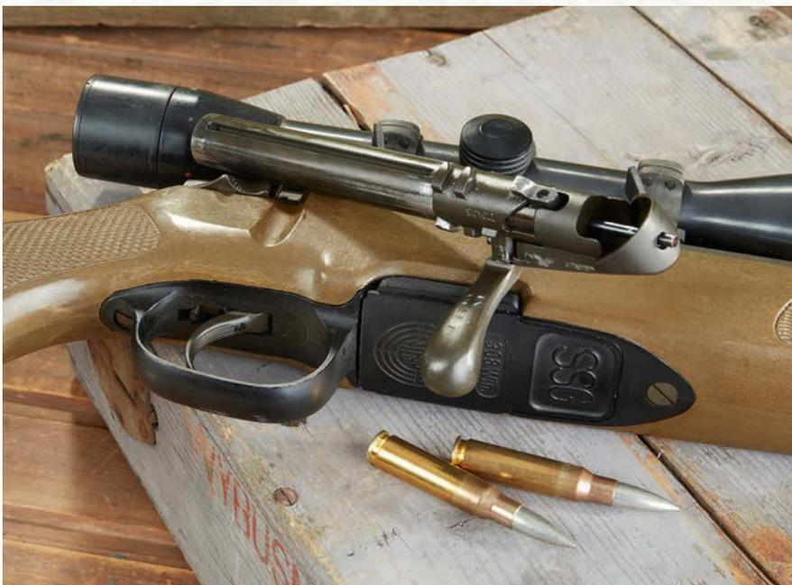
Der Verschluss mit den hintenliegenden, in Zweierpaaren gruppierten Riegelnocken. Ist er gespannt, ragt das rot eingelegte Schlagbolzenende über.
