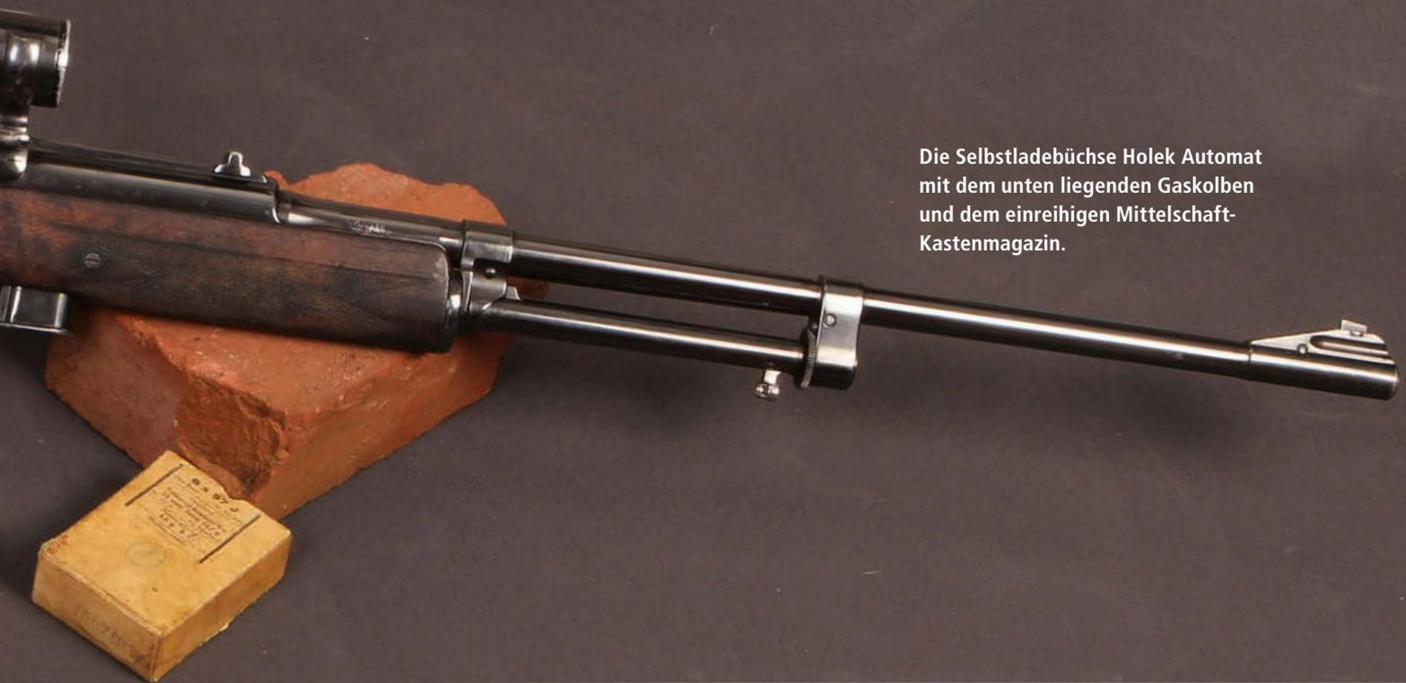
Die Selbstladebüchse Holek Automat mit dem unten liegenden Gaskolben und dem einreihigen Mittelschaft-Kastenmagazin.
