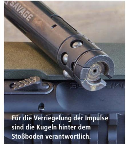
Für die Verriegelung der Impulse sind die Kugeln hinter dem Stoßboden verantwortlich.
