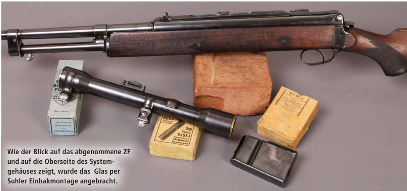
Wie der Blick auf das abgenommene ZF und auf die Oberseite des Systemgehäuses zeigt, wurde das Glas per Suhler Einhakmontage angebracht.
