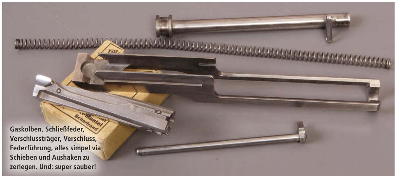
Gaskolben, Schließfeder, Verschlusssträger, Verschluss, Federführung, alles simpel via Schieben und Aushaken zu zerlegen. Und: super sauber!
