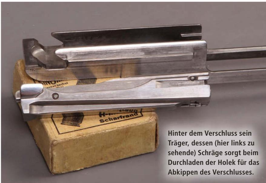
**Hinter dem Verschluss sein Träger, dessen (hier links zu sehende) Schräge sorgt beim Durchladen der Holek für das Abkippen des Verschlusses.**
