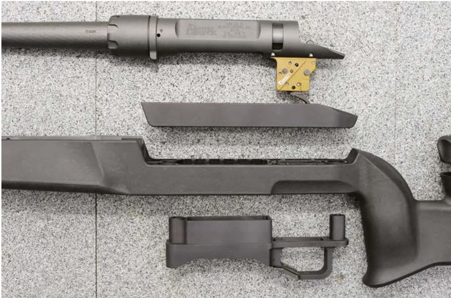
Allein die zwei Systemschrauben verbinden die vier Teile Lauf mit System, Systembettung, Schaft und Unterteil mit Magazinschacht und Abzugsbügel.
