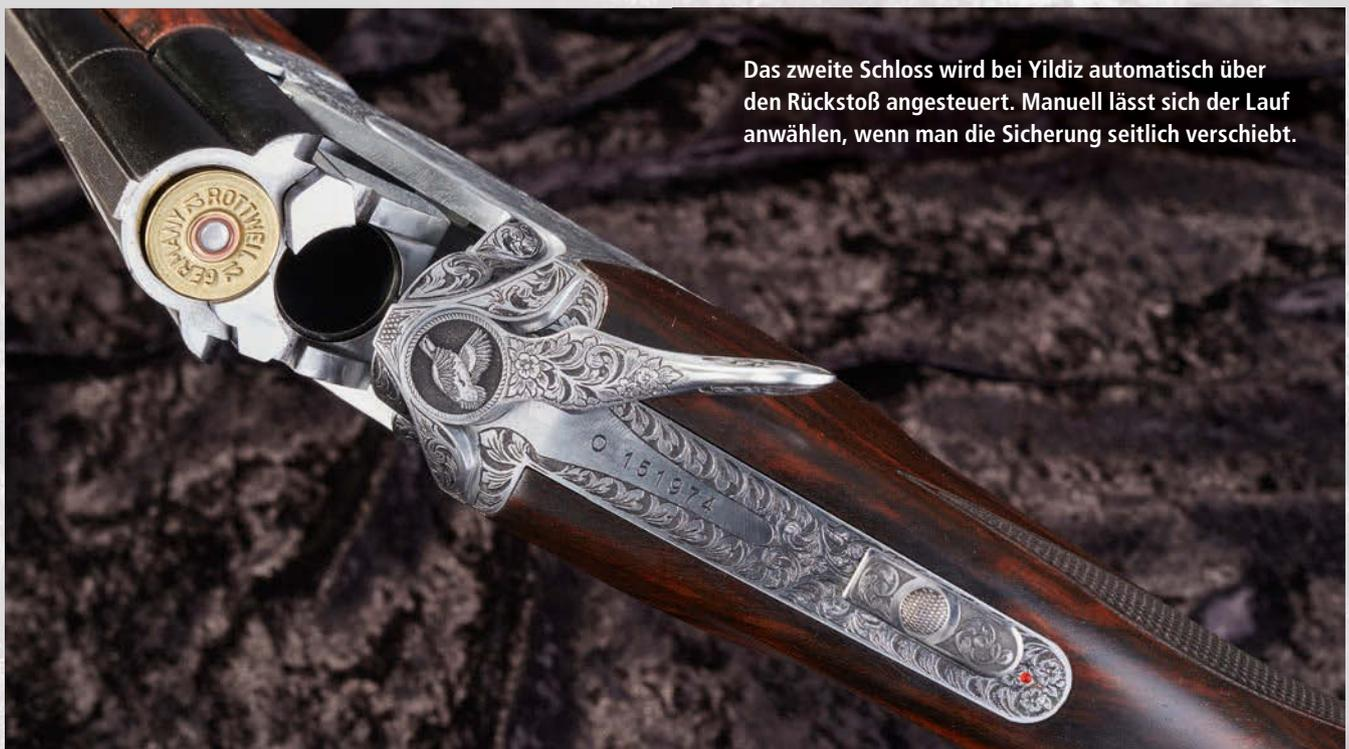
Das zweite Schloss wird bei Yildiz automatisch über den Rückstoß angesteuert. Manuell lässt sich der Lauf anwählen, wenn man die Sicherung seitlich verschiebt.
