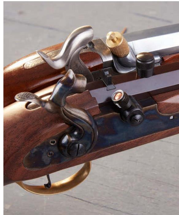
An der Pedersoli Le Page (hinten) lässt sich sehr gut erkennen, dass bereits ein Zündhütchen im Innern der Kapsel steckt. Das weit aus der Kapsel herausstehende Ende des Zündstiftes signalisiert zweifelsfrei „geladen“. Vorn das technisch ähnliche Pedersoli-Pendant mit abgeschraubtem Deckel.
