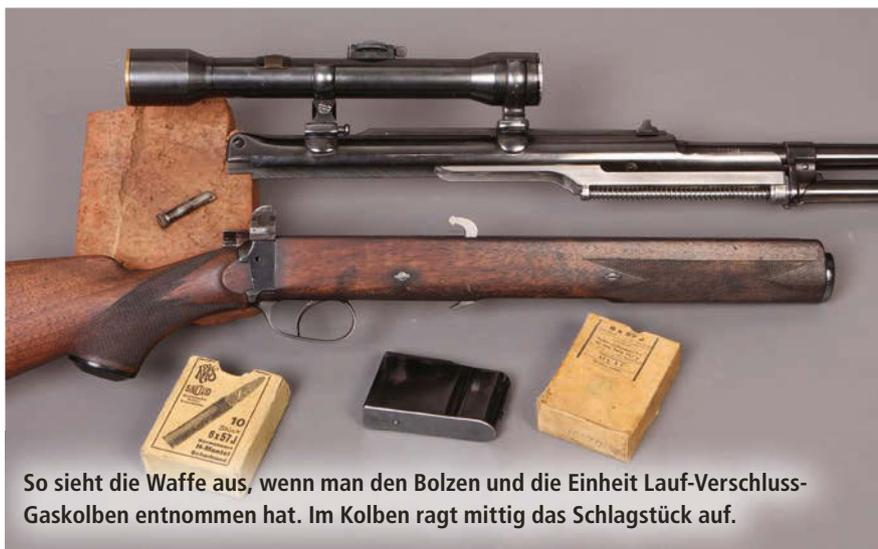
So sieht die Waffe aus, wenn man den Bolzen und die Einheit Lauf-Verschluss-Gaskolben entnommen hat. Im Kolben ragt mittig das Schlagstück auf.
