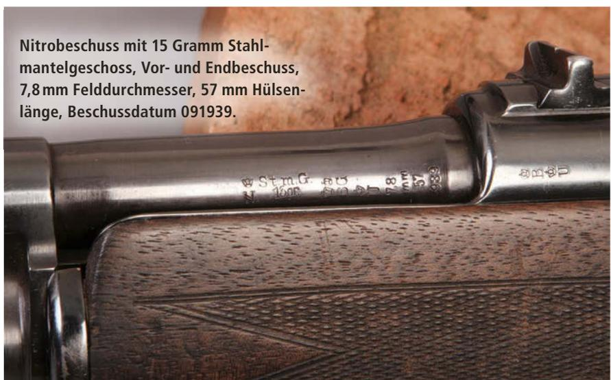
Nitrobeschuss mit 15 Gramm Stahlmantelgeschoss, Vor- und Endbeschuss, 7,8 mm Felddurchmesser, 57 mm Hülsenlänge, Beschussdatum 091939.
