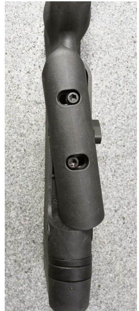
Zusätzlich lässt sich die Schaftbacke in beide Richtungen verschränken. Dazu von oben zwei Schrauben lösen und in deren Langlöchern die Backe versetzen.
