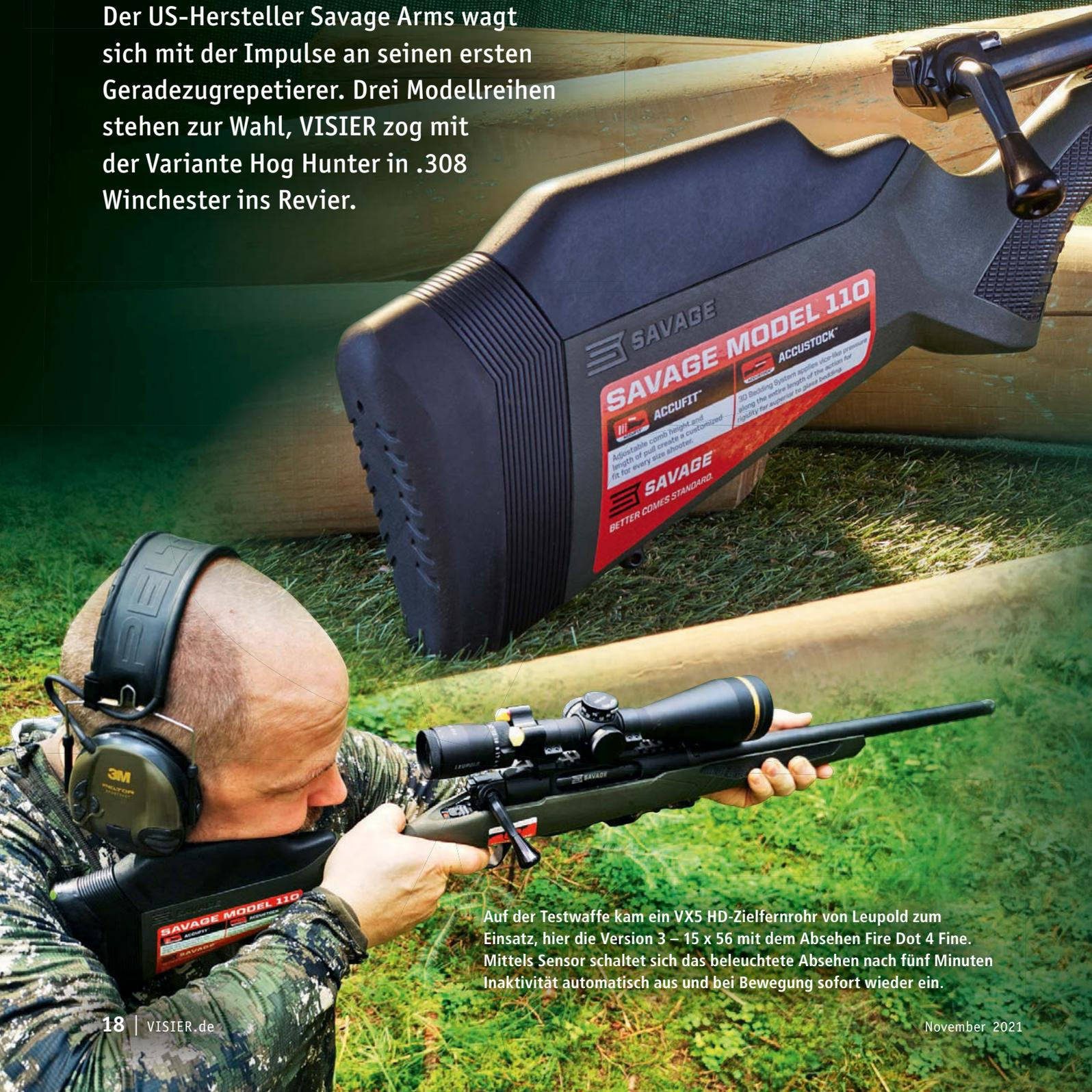
Auf der Testwaffe kam ein VX5 HD-Zielfernrohr von Leupold zum Einsatz, hier die Version 3 – 15 x 56 mit dem Absehen Fire Dot 4 Fine. Mittels Sensor schaltet sich das beleuchtete Absehen nach fünf Minuten Inaktivität automatisch aus und bei Bewegung sofort wieder ein.
