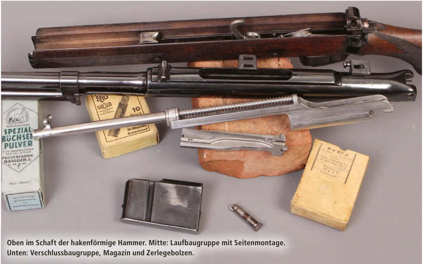
**Oben im Schaft der hakenförmige Hammer. Mitte: Laufbaugruppe mit Seitenmontage. Unten: Verschlussbaugruppe, Magazin und Zerlegebolzen.**
