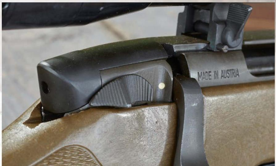
**Die Sicherung:** Oben (rot) ist die Waffe schussbereit. Unten (weiß) ist sie gesichert. In beiden Abbildungen ist sie nicht gespannt, sonst sähe man das Schlagbolzenende.
