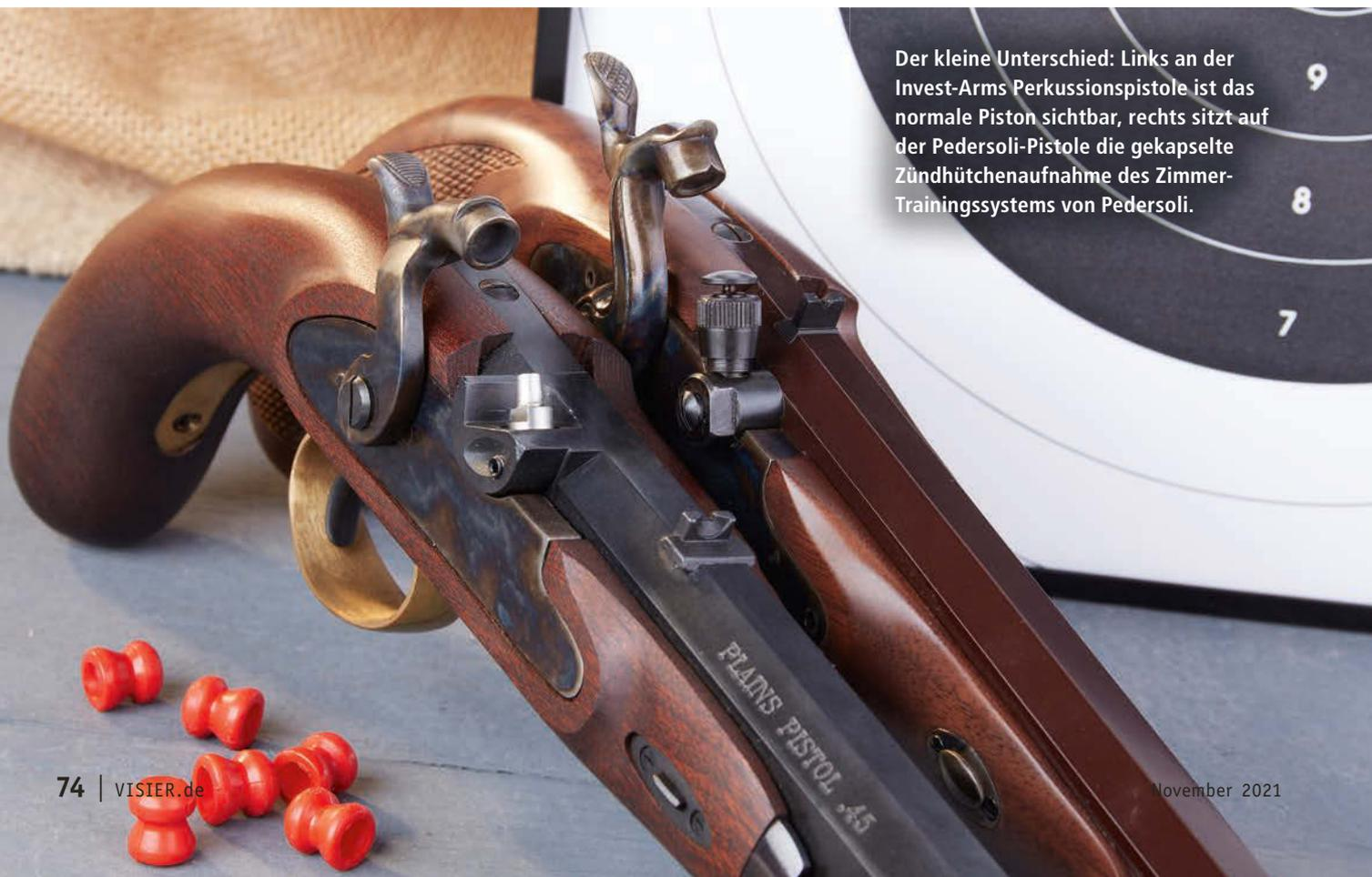
**Der kleine Unterschied:** Links an der Invest-Arms Perkussionspistole ist das normale Piston sichtbar, rechts sitzt auf der Pedersoli-Pistole die gekapselte Zündhütchenaufnahme des Zimmer-Trainingsystems von Pedersoli.
