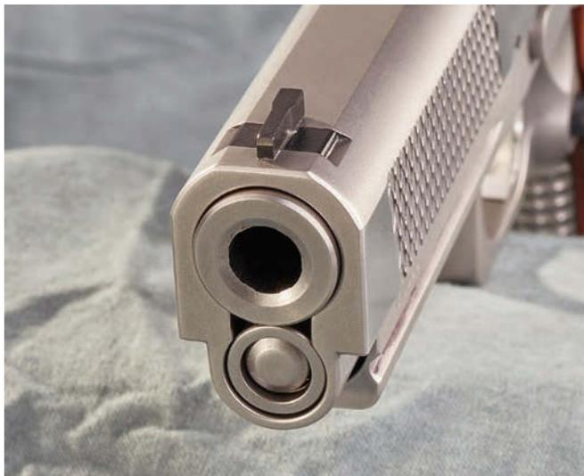
Der Lauf der Reptile wird ohne Bushing im Schlitten geführt. Die Federführungsstange läuft jedoch in einer Buchse.
