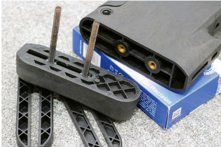
**Ein Langloch führt die Schaftkappenschrauben. Das erlaubt die Höhenverstellung. Unten liegen zwei unterschiedlich starke Schaftlängen-Spacer aus dem Zubehörpaket der Büchse Delta 5.**
