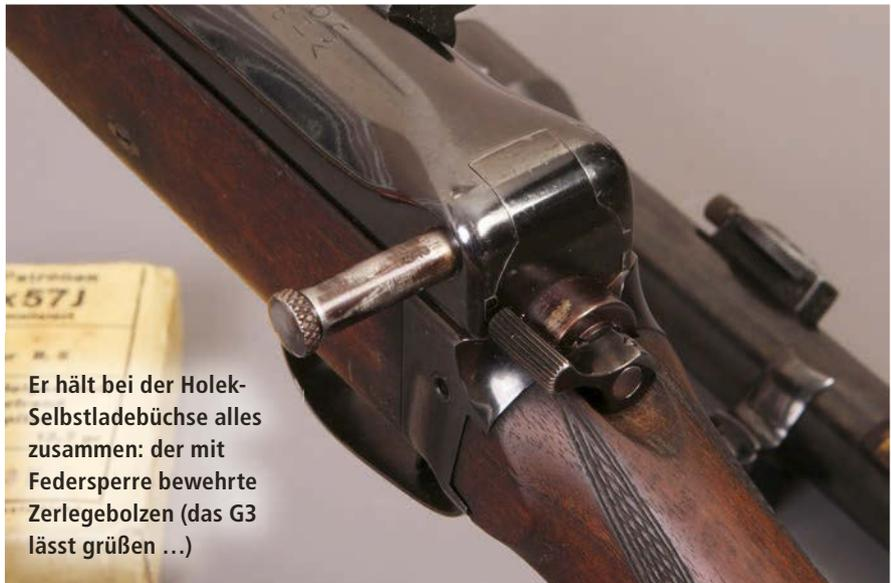
Er hält bei der Holec-Selbstladebüchse alles zusammen: der mit Federsperre bewehrte Zerlegebolzen (das G3 lässt grüßen ...)
