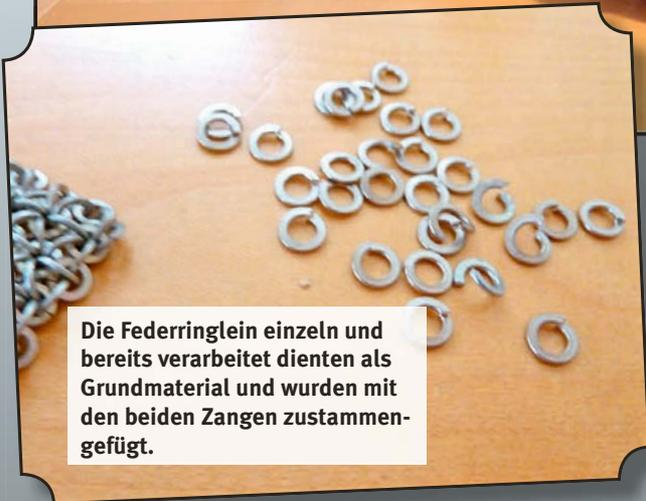
Die Federringe einzeln und bereits verarbeitet dienen als Grundmaterial und wurden mit den beiden Zangen zusammengefügt.
