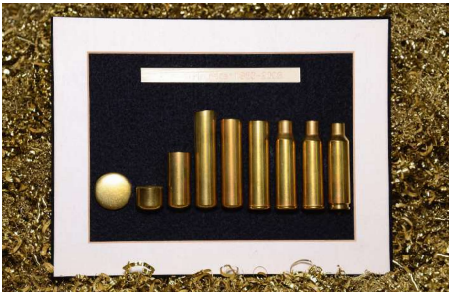
In 37 Jahren hat Dieter Horneber mit viel akribischer Tüftelei einen selten anzutreffenden Erfahrungsschatz rund um die Hülsenherstellung angesammelt. Hier die typischen Entwicklungsschritte von der Ronde bis zur fertigen Schulterhülse.
