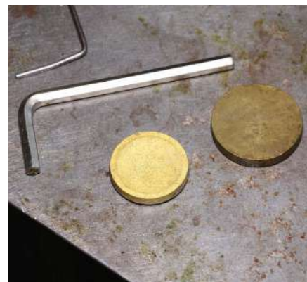
Je nach Kaliber sind der Durchmesser und die Stärke der Ronde unterschiedlich. Rechts: die Ronde für eine .700 H&N Nitro Express.
