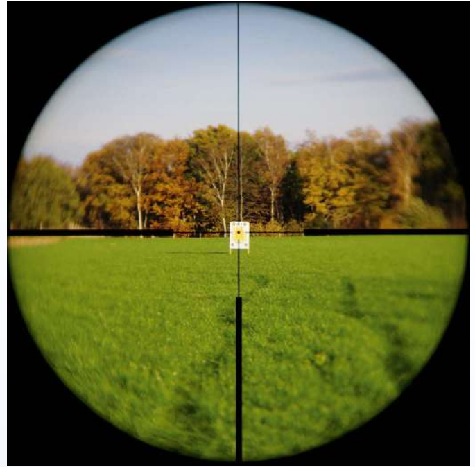
Falke, Vergrößerung 1x, Entfernung 50 Meter: Die Markierungen sind nicht zu sehen, weil das Sehfeld mit 14,25 Meter nicht ausreicht. Auf 100 Meter sind es 28,5 Meter, erheblich weniger als die 33 Meter die man verspricht (siehe technische Daten). Wer damit leben kann, wird durch eine sehr große Austrittspupille und einen sehr angenehmen Preis entschädigt.
