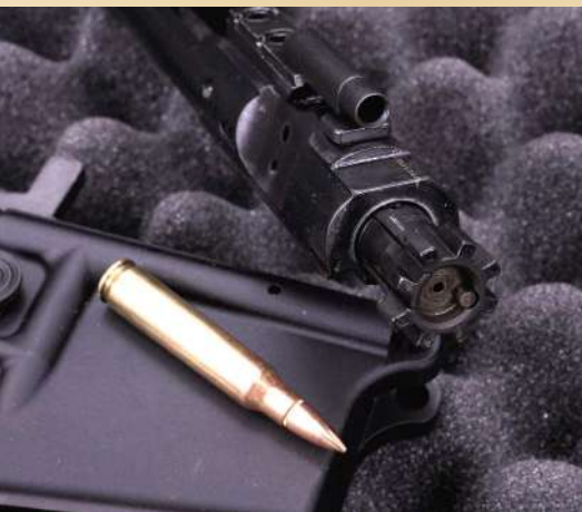
Goldener Standard: Direktes Gasdruckladesystem nach Eugene Stoner mit dem klassischen Multiwarzen-Drehkopfverschluss.
