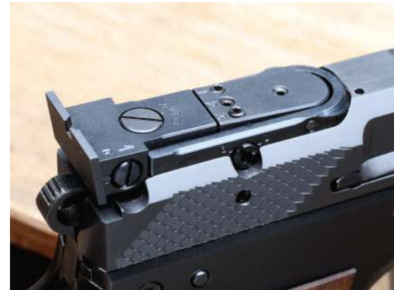
Das Aristocrat-Visier wurde extrem tief in den Verschluss eingelassen. Damit der Hammer das Visierblatt nicht berührt, wurde er auf seiner Oberseite kaum wahrnehmbar abgeschliffen.
