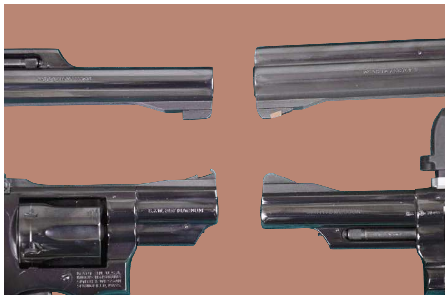
Im Uhrzeigersinn, von links oben: Patridge Korn, Schlepkkorn mit roter Einlage, Schlepkkorn ohne Einlage, Schlepkkorn mit entfernter Einlage.
