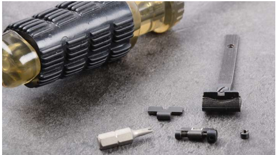
Falls das Korn nicht zu tauschen ist, können bei einer verstellbaren Kimme die Blätter getauscht werden.
