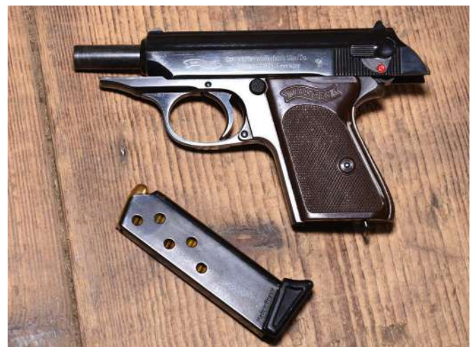
Die Walther PPK mit simplem Masseverschluss und feststehendem Lauf bei zurückgezogenem Schlitten.
