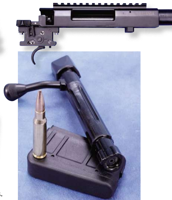
Wie bei Brenner BR18: Systemkasten mit flacher Unterseite und Zylinderverschluss mit 60-Grad-Öffnungswinkel und drei Verriegelungswarzen, die im Systemkasten verriegeln.
