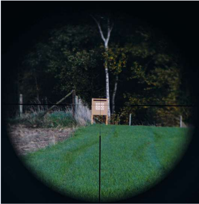
Leica Fortis, Vergrößerung 6x, Entfernung 100 Meter: Der Leuchtpunkt hat einen Durchmesser von 2,5 cm und die Fäden des feinen Fadenkreuzes decken nur 0,5 cm ab. Sehr großes Sehfeld von 7,1 Meter.
