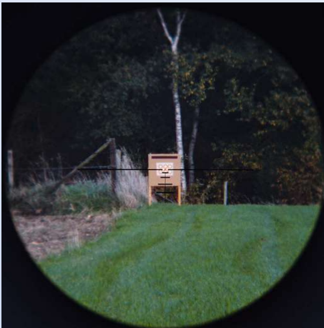
Noblex Inception, Vergrößerung 6x, Entfernung 100 Meter: Der Leuchtpunkt des BDC-Absehens hat einen Durchmesser von 3 cm. Das Sehfeld ist mit 6,1 Meter ausreichend groß.
