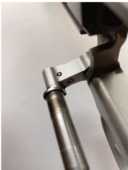
Die zusätzliche Trommelverriegelung befindet sich auf der Innenseite des Trommelkrans.
