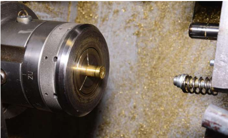
Letzter Arbeitsgang: Die Hülse wird spanabhebend bearbeitet und dabei die Ausziehrille eingebracht. Gut zu erkennen: die noch glänzende Ausziehrille wurde mit einem Drehmeißel eingebracht.
