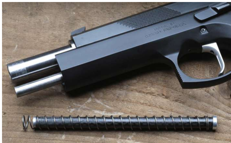
Um unter dem 1.300-Gramm-Limit der BDS-Standardklasse zu bleiben, gibt's die Karbon-Federführungsstange, die ein bisschen Rennsport-Feeling aufkommen lässt.
