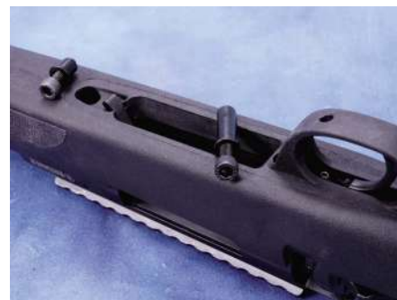
Wie bei Brenner BR18: Systemkasten mit flacher Unterseite und Zylinderverschluss mit 60-Grad-Öffnungswinkel und drei Verriegelungswarzen, die im Systemkasten verriegeln.
