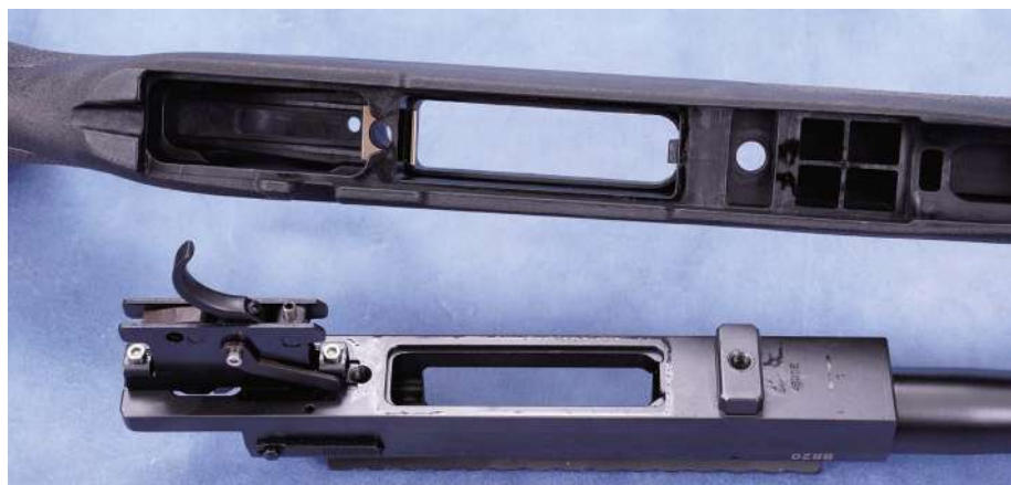
Blick auf die angesichts des Niedrigpreises ordentliche Systembettung mit einer ungewöhnlichen Abwandlung des klassischen „Pillar Bedding“.
