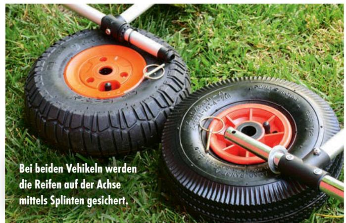
Bei beiden Vehikeln werden die Reifen auf der Achse mittels Splinten gesichert.
