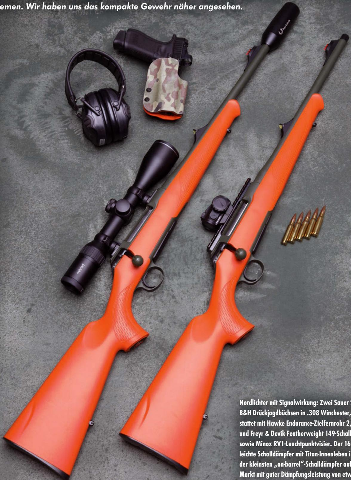
Nordlichter mit Signalwirkung: Zwei Sauer S100 B&H Drückjagdbüchsen in .308 Winchester, ausgestattet mit Hawke Endurance-Zielfernrohr 2,5-10x50 und Freyr & Devik Featherweight 149-Schalldämpfer sowie Minox RV1-Leuchtpunktvisier. Der 164 Gramm leichte Schalldämpfer mit Titan-Innenleben ist einer der kleinsten „on-barrel“-Schalldämpfer auf dem Markt mit guter Dämpfungsleistung von etwa 20 db.
