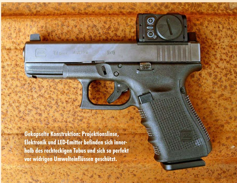
**Gekapselte Konstruktion: Projektionslinse, Elektronik und LED-Emitter befinden sich innerhalb des rechteckigen Tubus und sind so perfekt vor widrigen Umwelteinflüssen geschützt.**
