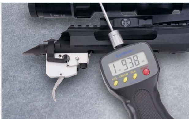
Trotz insgesamt sauberer Charakteristik war das Abzugsgewicht der originalen Abzugseinheit etwas hoch. Justierungen am Abzug oder der Einbau eines Matchabzuges schaffen hier aber schnell Abhilfe.
