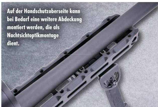
**Auf der Handschuttoberseite kann bei Bedarf eine weitere Abdeckung montiert werden, die als Nachtsichtoptikmontage dient.**
