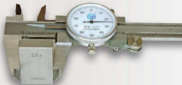
**Ein präziser Messschieber mit Uhr und einer Auflösung von 0,001“ gehört auch zum Lieferumfang des Hornady Classic Deluxe Kit. Unsere Kontrolle mit einem Parallel-Endmaß der Klasse Null beweist die Präzision.**
