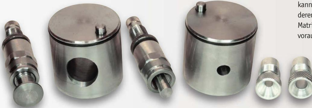
Zwei Zylinder mit Kolben und Schüttrohren. Wir sind der Meinung, dass diese Rohre in Kombination mit dem Ständer etwas zu kurz geraten sind. Zum Füllen der Hülsen unproblematisch, aber wenn Pulver in die Schale der Waage geschüttet wird, ist die Entfernung zum Schalenboden zu groß, wodurch Körner aus der Schale springen können.
