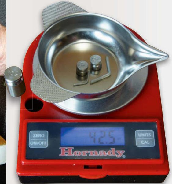
Die kleine Hornady G2-Waage arbeitet präzise. 42,5 Grains in der Schale sind 42,5 Grains in der Anzeige.
