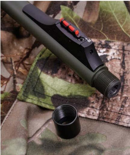
Der um 10 cm gekürzte Lauf mit M15x1-Mündungsgewinde und Abdeckblende.
