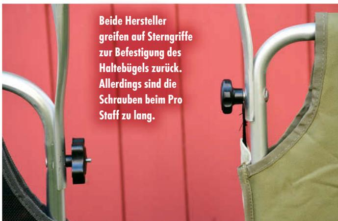
Beide Hersteller greifen auf Sterngriffe zur Befestigung des Haltebügels zurück. Allerdings sind die Schrauben beim Pro Staff zu lang.
